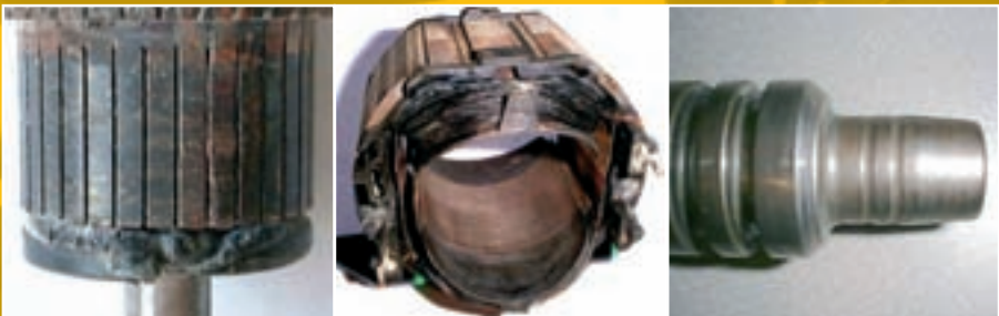
Λιωμένο ακραίο τμήμα - υπερφόρτωση Λιωμένοι ακροδέκτες περιελίξεων πεδίου Φθαρμένο εξάρτημα κρούσης
