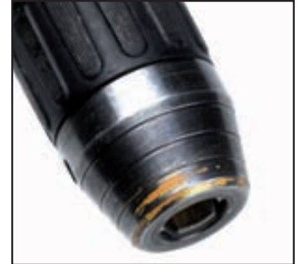
Φθορά που προκλήθηκε από επαφή του τσοκ με τοιχοποιία ή άλλες σκληρές επιφάνειες κατά τη λειτουργία του δραπάνου
