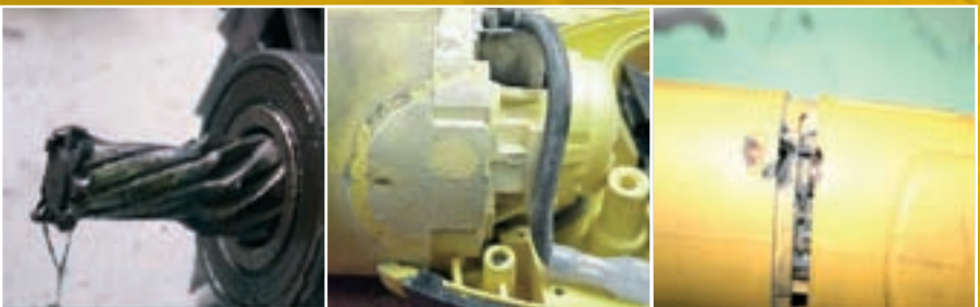
Φθορά πινιόν Μεγάλου βαθμού ρύπανση / κατάλοιπα Ζημιά από δραστηριότητα στίλβωσης με τροχό
