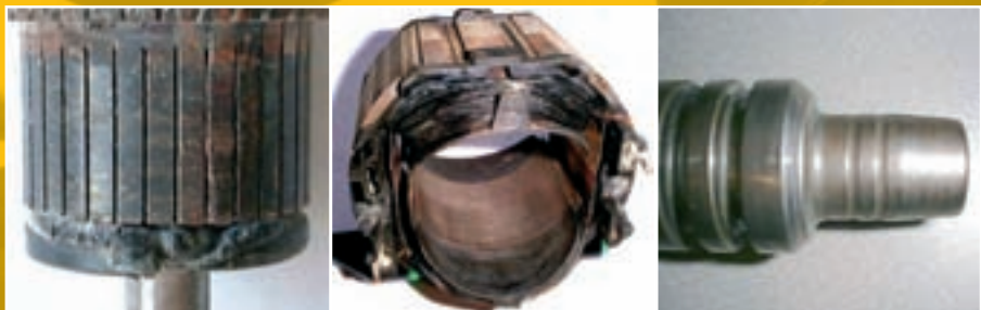
Gesmolten eindstuk - overbelasting
