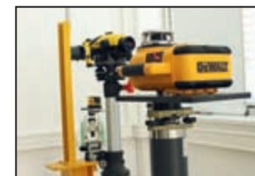
Se l'unità ha un ottica non allineata, si prega di consultare il manuale utente nella sezione "controllo della calibrazione" (o "controllo di precisione"). Se il controllo della calibrazione non risolve il problema, il laser deve essere riparato e tarato da personale autorizzato DEWALT.
