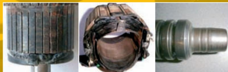
Collettore fuso per sovraccarico    Terminali statore fusi    Percussore usurato
