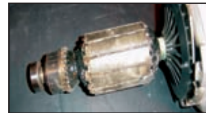
Maskinen er udbrændt (overbelastet)
