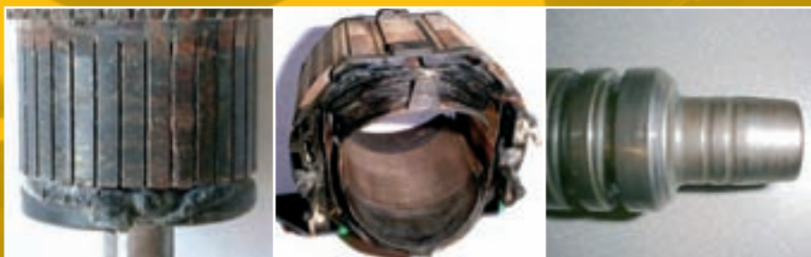
Smeltet endestykke - overbelastet Smeltede feltudtag Slidt slagdel
