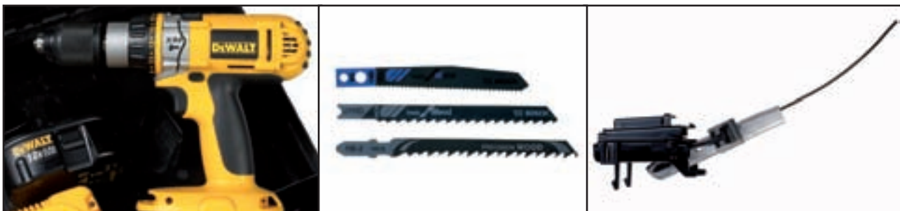
Revnet gearhus på grund af misbrug af værktøjet Der skal bruges korrekt klingetilbehør En bøjet slagbolt viser, at sømmet har ramt noget inden i trækabinettet, som har sendt belastning tilbage på slagbolten.
