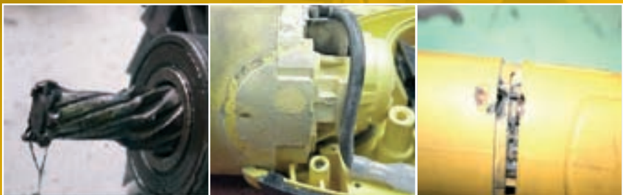
Slidt tanddrev Ekstrem mængde forurening/rester Skader, som skyldes polering med slibeværktøj
