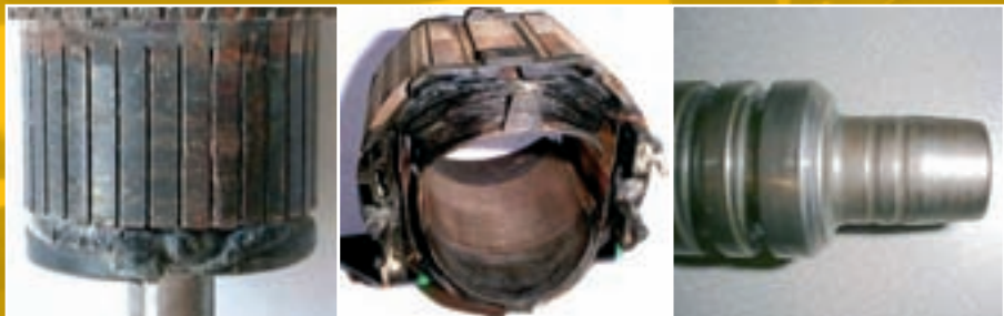
Sulanut pääkappale - ylikuormitus
