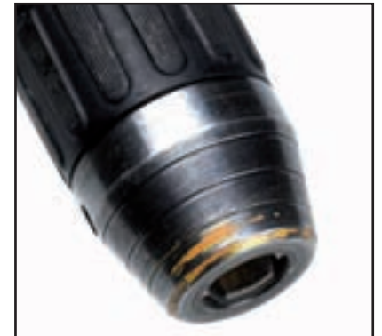
Jos kuluminen johtuu poran käyttämisestä istukan ollessa muurausta tai muuta kovaa pintaa vasten
