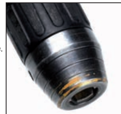
Slitasje som skyldes bruk av drillen der chucken kjøres mot murverk eller andre harde overflater.
