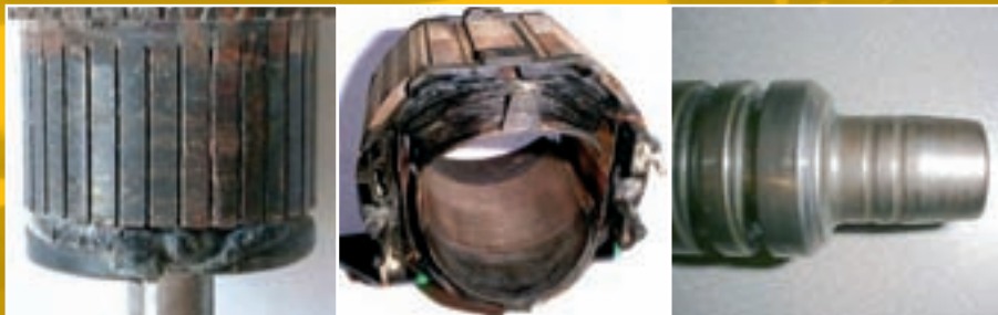
Smeltede endestykker - overbelastet
