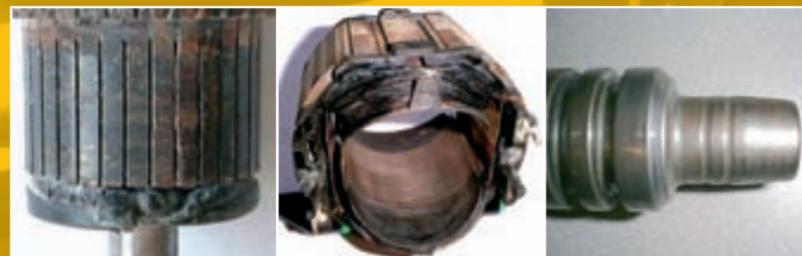
Derreteu parte final - sobrecarga    Terminais indutora derretidos    Pistão batente com desgaste
