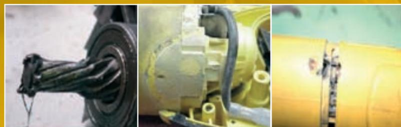
Pinhão desgaste    Contaminação de resíduos no interior da máquina    Danos causados pelo uso de rebarbadoras para polimento
