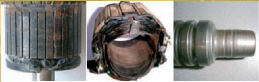
Megolvadt végdarab - túlterhelés
