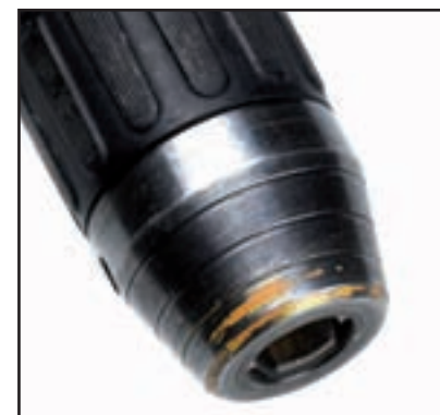
Opotřebování způsobené provozem vrtačky se skličidlem do zdiva nebo do jiného tvrdého povrchu
