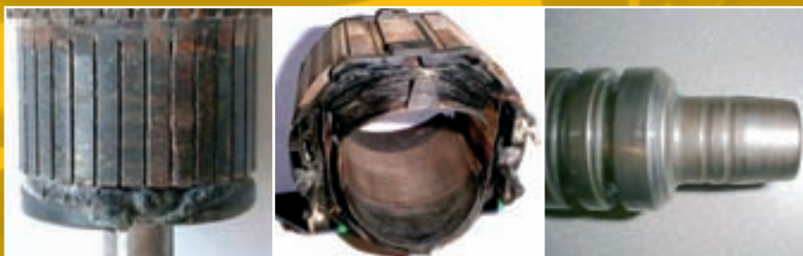
Roztavený koncový kus - přetížení
