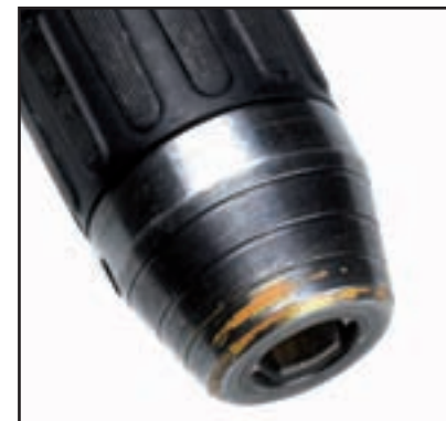
Zużycie na skutek eksploatacji uchwytu wiertarskiego w pracach związanych z wierceniem w murze lub innych twardych powierzchniach
