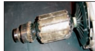
Spalony twornik (przeciążony)
