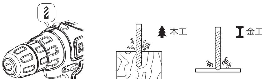
穴あけ作業には、11段階目のクラッチポジション“”の位置にクラッチをセットしてください。この位置ではトルク調整装置が作動しませんので、無理な作業を行うとモーターを痛めてしまうので注意してください。
