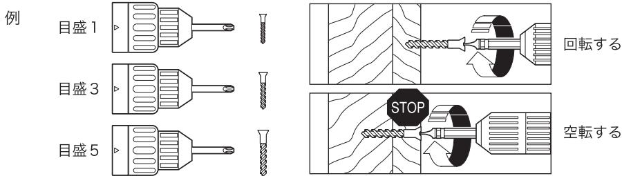
太いネジには高いトルク設定が必要ですが、細いネジにはあまり高いトルクはかえってネジを痛めます。何本かのネジ締めをする時に、最初の一本目でネジの頭が板とピッタリ平面になるところで回転が止まるようなトルクを見つけてそのトルクに設定しますと、二本目以後のネジ締めで平面を出すのが容易になります。
