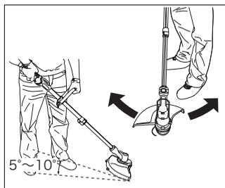
図のような姿勢で本製品を約5cmほど浮かした状態で保持し、ヘッドを左右に振りながら前進して、乾いた草を刈ってください。本体はゆっくり動かし、必ずこの向きでご使用ください。
