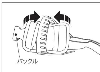
左図のようにバックルを外したショルダーストラップはサポートハンドルの下に通し、面ファスナー部分を合わせてサポートハンドルに付けてください。ハンドルの下に通したバックルをとめてからストラップの長さを調節してください。
