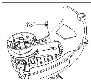
(2) 防護カバーの裏側にネジがテープ留めされています。プラスドライバーを使用し、図のように防護カバーをネジで固定してください。
