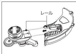
(1) 図のように本体を裏返し、防護カバーのレールを本体のレールに沿わせるようにして、防護カバーを奥までしっかりと差し込んでください。
