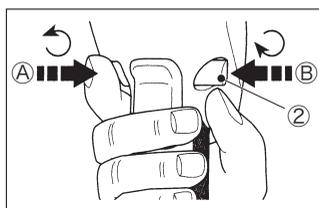
左図の方向から見て、正転/ロック/逆転スイッチ(②)をAから一杯に押すと正転します。スイッチをBから一杯に押すと逆転します。このスイッチを中央位置にセットしておくと、トリガースイッチがロックされて動かなくなります。使用しないときは、ロックをかけた状態にしておいてください。このスイッチの位置を替えるときは、必ずトリガースイッチを放してください。
