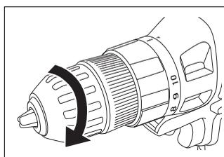
(2) チャックカバー後半部を押さえながら、前半部を時計回り(→↻)の方向：鍵を閉じるマークの方向)に回してキーレスチャックを締めてください。キーレスチャックの3本の爪がビットを挟み込み、固定します。
