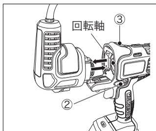
(2) 取り外すには、正転/ロック/逆転スイッチ (2) を中央位置にセットし、ヘッドリリースボタン (3) を押しながら取り外します。
