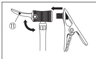
英式アダプターをインフレーターヘッドの先端部分のレバー (1) を上げて、差し込んだ後、レバーを下げてお使いください。
