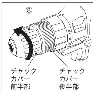
(1) 本製品にはキーレスチャック(⑧)が装備されています。チャックカバー後半部を押さえながら、前半部を反時計回り(←↺)の方向：鍵が開くマークの方向)に回してチャックを開いてください。使用するビットを開いたチャックの中に20ミリ程度押し込んでください。
