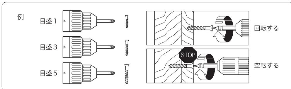
太いネジには高いトルク設定が必要ですが、細いネジに高いトルクはかえってネジを痛めます。何本かのネジ締めをする時に、最初の一本目でネジの頭が板とピッタリ平面になるところで回転が止まるようなトルクを見つけてそのトルクに設定しますと、二本目以後のネジ締めで平面を出すのが容易になります。
