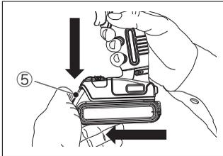
(1) 充電電池を製品本体から取り外すには、正転/ロック/逆転スイッチを中央のロック位置にセットして、モーターが誤って回転しないようにしてください。
