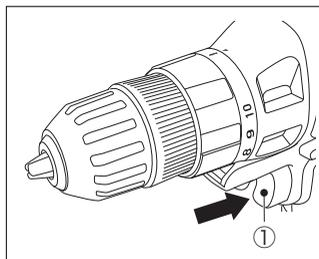
左図のように、無段変速トリガースイッチ(①)を引くと作動します。またトリガースイッチを放せば止まります。トリガースイッチには無段変速機能が組み込まれていますので、深く引くと高速、浅く引くと低速というように速度を調節できます。作業の内容に合わせてトリガーの引き具合で速度を調節できるので大変便利です。
