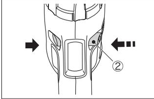
(1) 充電電池を本製品に取り付けるには、正転/ロック/逆転スイッチ (2) を中央のロック位置にセットして、モーターが誤って回転しないようにしてください。
