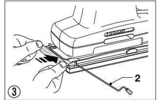
研磨シートのサイズは92mm × 230mmです。市販の研磨シート279mm × 230mmを3等分にカットしても使用できます。研磨シートを取り付ける前に、研磨シートの研磨面の裏側を作業台の角などでこすり、柔らかくすると取り付けが楽に行えます。
