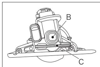
スピンドルロックボタン (B) をしっかり押しこんだ状態で、レンチ (C) を使用して固定ボルトを取り外してください。固定ボルトは逆ネジとなっていますので、取り外すには時計回りに回してください。
