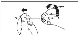
(2) 一方の手でチャックの後半部を持ち、もう一方の手で時計の針と同じ方向(●→の方向)にチャックカバーを回してキーレスチャックを締めてください。作業が終わったら、再びチャックカバーを時計の針と逆方向(←●の方向)に回し、ビットを取り外してください。
