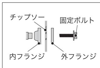
丸ノコチップソーを取り付けるときは、図のように内フランジ、チップソー、外フランジ、固定ボルトの順にレンチを使用して固定ボルトを反時計回りに回し、しっかり締め付けて固定してください。尚チップソーを取付ける際はチップソーの向きに注意してください。チップソー上の印刷面が外側（見える面）になるように取り付けてください。
