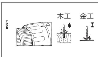
深くネジを埋め込む作業や穴開け作業には、“2”の位置にクラッチをセットしてください。この位置では、回転トルク調節が作動しません。
