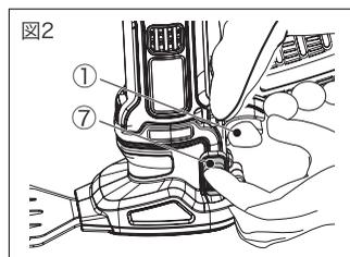
(2) ガーデンヘッド側のロックオフスイッチ (⑦) を持ち上げながらトリガースイッチ (①) を引き込むとブレードが動きます。(図2)
