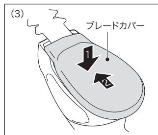
(3) 図(2)のようにブレードを支えたまま、図(3)のようにブレードカバーを置き、カチッとロックされる感触があるまで前方にスライドさせてください。
