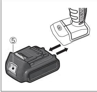
(1) スライド式充電電池を本製品に取り付けるには、この製品の握り部分の下にある挿入口に前方から充電電池を後方にスライドさせ「カチッ」としっかりとハマるまで充電電池を差し込んでください。
