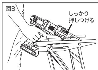
図Bのように枝切りヘッド前方にあるプレートを対象の枝に押し付け切断作業を行ってください。ブレードの角度を変えながら作業をすると効率的に切断することができます。
