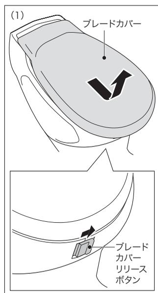
(1) 本機後部のブレードカバーリリースボタンを図のようにスライドさせたまま、ブレードカバーを図のようにスライドさせて外してください。
