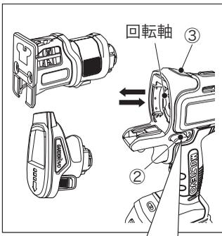
(1) 取り付けるには、正/逆転ロックスイッチ (②) を中央位置にセットし、本体前面の挿入口に「カチッ」としっかりとハマるまでヘッドを差し込んでください。
