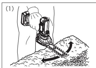
(1) 本機を図のように持ち、スイッチを入れ、せん定する方向に向かって本機を少し傾けて（最大15度）、ゆっくりと左右に本機を移動させてください。
