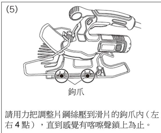
修剪高度調整片的拆卸，請依照上述相反的順序（滑片、修草機刀片、調整片鋼絲的順序）進行。
