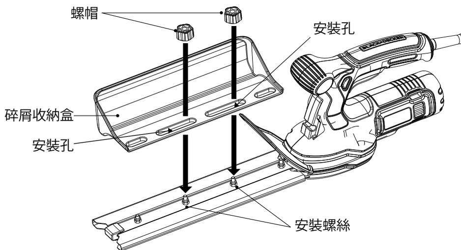
安裝時，請將碎屑收納盒的安裝孔對準修枝機的2根安裝螺絲，使用螺帽暫時裝上。拆下保護蓋之後，請確實扭緊螺帽加以固定。拆卸時，請鬆開螺帽拆下碎屑收納盒。
