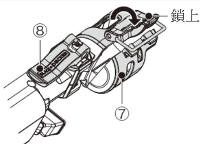
請解除機體接頭(⑦)鎖，打開機體接頭。待機體接頭斜下來時，開啟角度調整桿(⑧)，請再將機體接頭復原扳直，關上調整桿固定。
