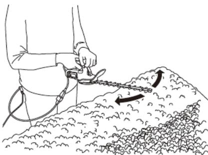
本機可以修剪最粗  $\phi 8\text{mm}$  的細枝及雜草。
