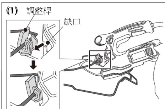
如上圖般，機體前方置入調整片鋼絲（參照 P5）內，將調整桿的桿子嵌入機體的缺口。
