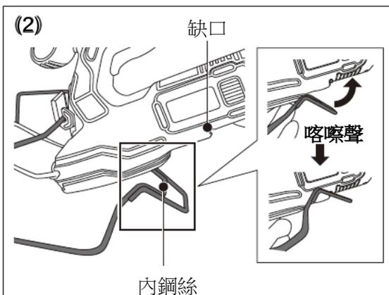
請將調整片鋼絲後方的內鋼絲嵌入機體的缺口。
