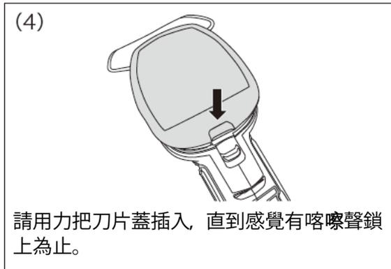
刀片的卸除如圖 (1) 般，拆下刀片蓋，卸下修草機刀片之後，請如圖 (4) 般裝回刀片蓋。
