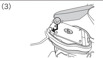
図(2)のようにブレードを支えたまま、ブレードカバー左右のツメを本体に引っかけるように置いてください。
