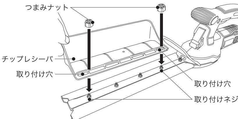
取り付けは、チッププレシーバの取り付け穴を庭木バリカンの取り付けネジ2本に合わせ、つまみナットで仮締めを行ってください。保護カバーを取り外した後、しっかりとつまみナットを締め付け固定してください。
