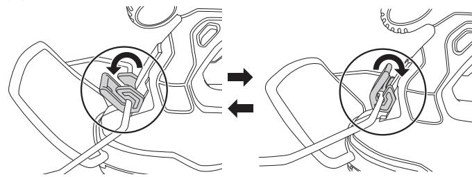
図(2)のように草丈調整レバーを動かすと、草丈を調整できます(2段階)。
