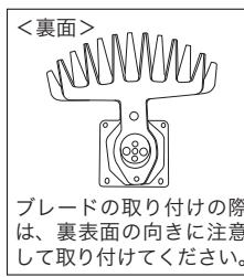
ブレードの取り付けの際は、裏表面の向きに注意して取り付けてください。
