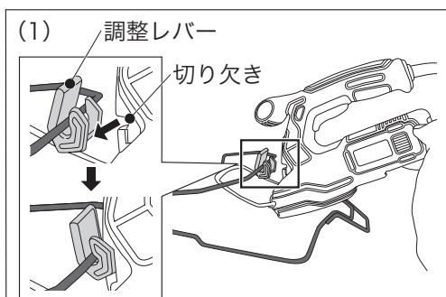
上図のように本体前部をガイドワイヤ（P5参照）にくぐらせ、調整レバーのバーに本体の切り欠きをはめてください。
