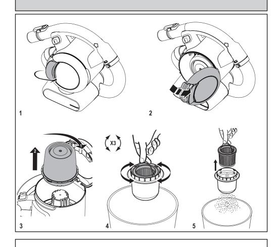
Re-assemble after cleaning the filter or continue to wash. 필터를 청소한 후 재조립하거나 계속 씻습니다.
