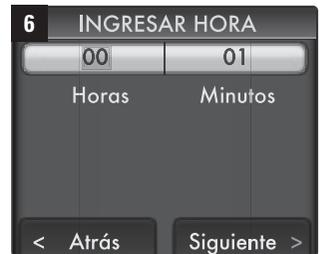
Utilice el teclado y las teclas de navegación para configurar la hora y luego oprima "siguiente" para continuar
