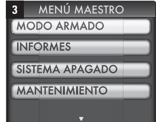
3 Use las teclas de navegación para seleccionar el modo "Armado" y oprima "OK"
