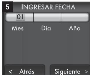
Utilice el teclado y las teclas de navegación para configurar la fecha y luego oprima "siguiente" para continuar
